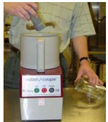
Paso tres: coloque la lamina S en el eje de motor dentro del tazon y gire en sentido contrario al del las agujas del rolog hasta que esta se cierre en el lugar.
