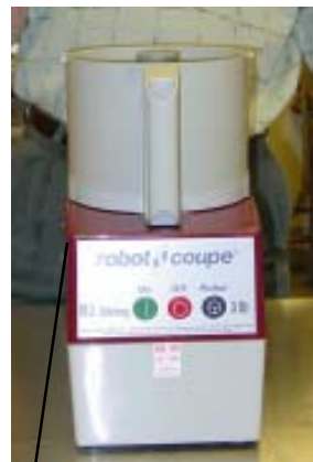
Paso dos: Haga girar el tazon en sentido contrario al de las agujas del reloj hasta que el mango sea centrado en el frente.
