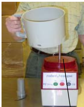
Paso un: El lugar desconcierta el eje de motor colocado con el mango ligeramente a la izquierda.
